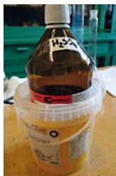
Rys. 2. Butla z kwasem umieszczona w plastikowym pojemniku.
